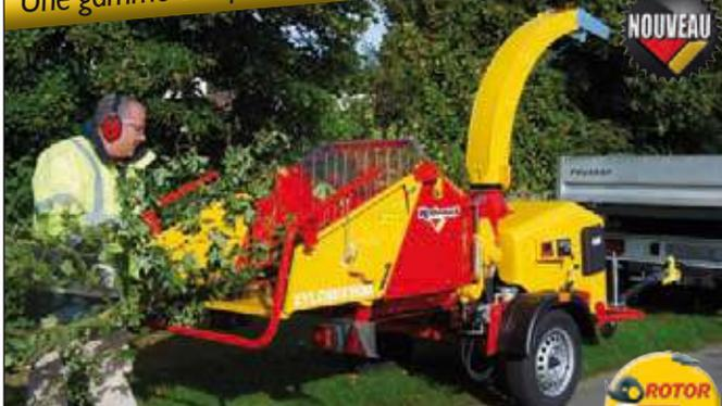
XYLOMIX 150M : Broyeur de branches Ø 150 mm avec
