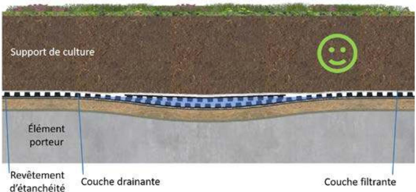
**Figure 4** : schéma en coupe d'une compensation de planimétrie par augmentation ponctuelle de l'épaisseur de la couche drainante (dessin de Cédric Houel).
