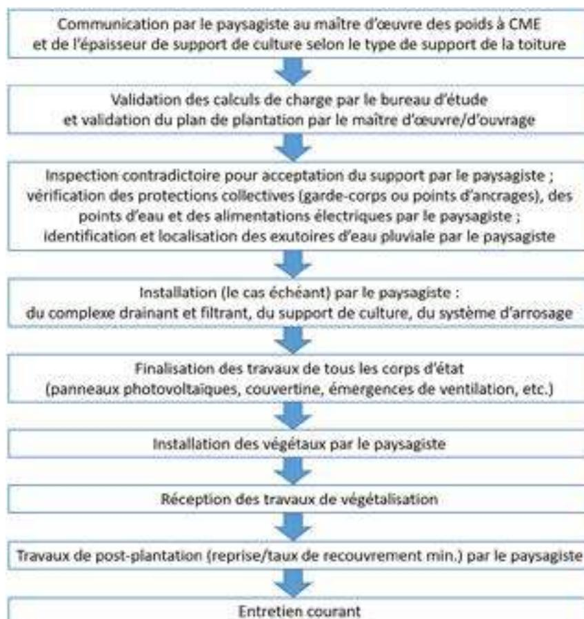
**Figure 1 :** schéma de planification de la réalisation d'une toiture végétalisée.
