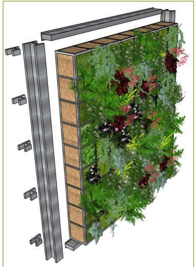
**Figure 7 :** Schéma d'un exemple de cassettes métalliques modulaires. Dessin : Cédric Houel.
