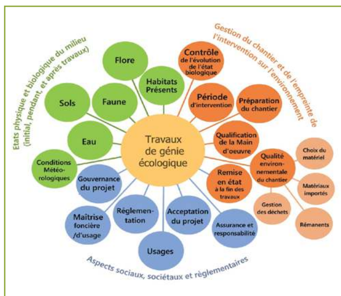
Figure 1. Schéma récapitulatif des paramètres à prendre en compte pour réaliser des travaux de génie écologique
