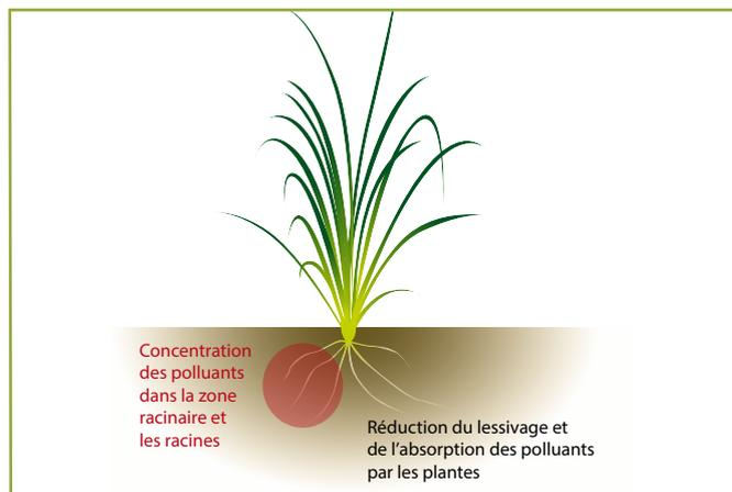
Figure 4 : Schéma de fonctionnement de la phytostabilisation
