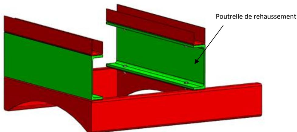
**Figure 3 - Vue en perspective de la solution proposée**
