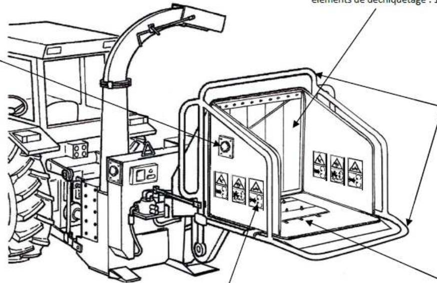
③ Veiller à la présence et au bon fonctionnement de la barre de sécurité (ou d'un dispositif équivalent) : 1.3.7, 1.3.8.2, 1.4.1 et 1.4.3
