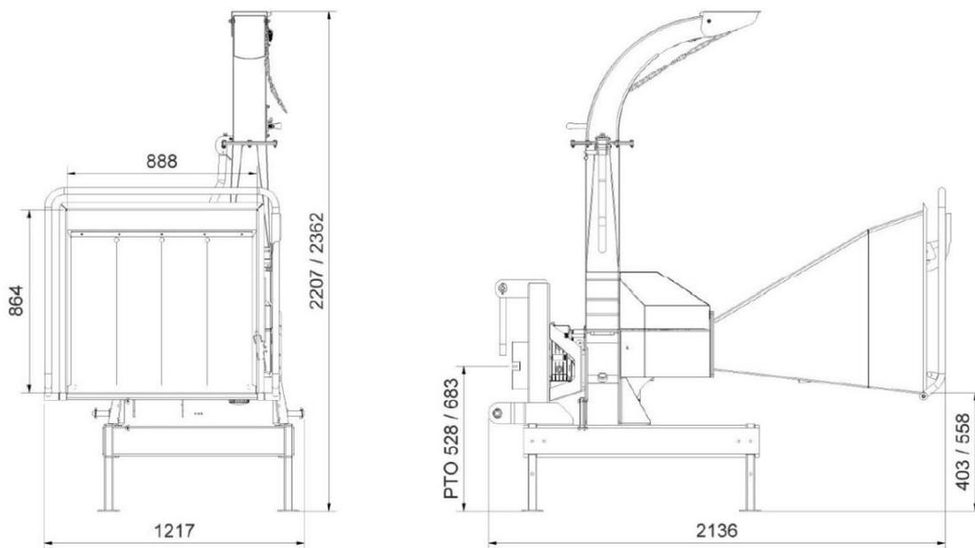
**Figure 4 – Caractéristiques dimensionnelles de la déchiqueteuse**
