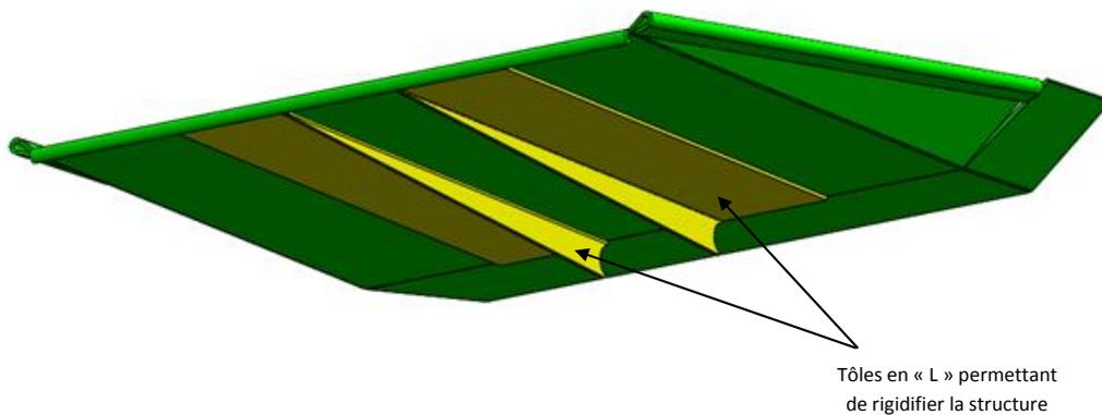
**Figure 8 - Table principale équipée de tôles de renfort**
