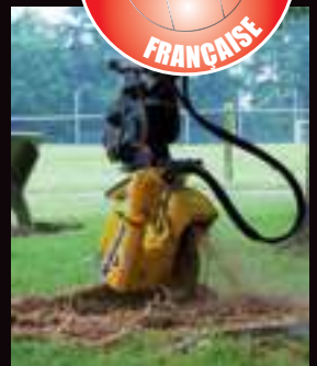
ROGNEUSES DE SOUCHES XYLOCROK 2 MODÈLES SUR PELLE DE 2,5 À 10 T
