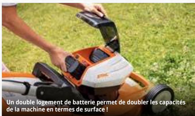
Un double logement de batterie permet de doubler les capacités de la machine en termes de surface !
