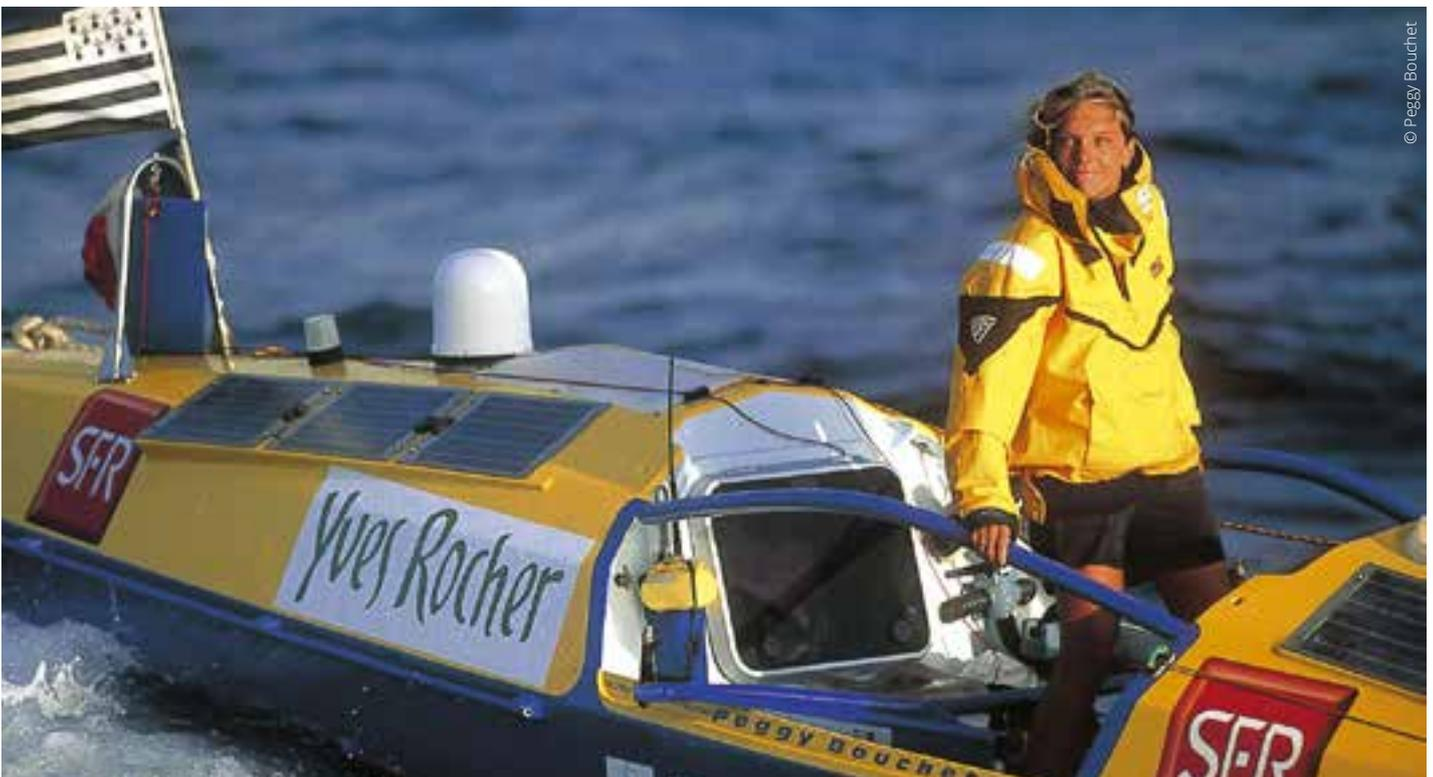
LE BATEAU CONSTRUIT EN CONTREPLAQUÉ ET RÉSINE ÉPOXY POUR UN POIDS DE 300 KG À VIDE ET 650 KG EN CHARGE
