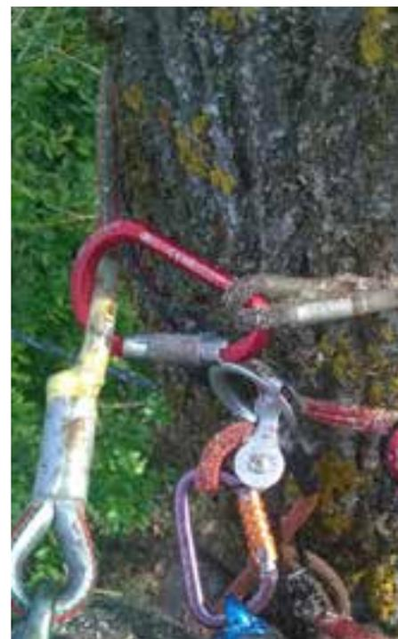
CORDES ET ANCRAGES NÉCESSAIRES POUR UNE INTERVENTION DE BILLONNAGE SUR UN TRONC : LONGE ARMÉE AVEC SYSTÈME ÉTRANGLEUR PERMETTANT D'ÉVITER LES CHUTES EN CAS DE DÉGRIFFAGE, CORDE DE RAPPEL AVEC FAUSSE FOURCHE ÉTRANGLEUSE.
