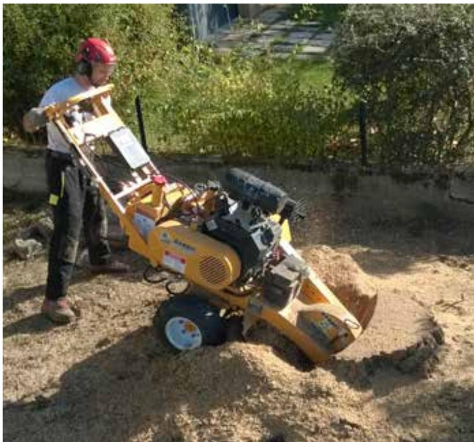
TRAVAIL DE ROGNAGE DE SOUCHE À L'AIDE D'UNE ROGNEUSE, JUSQU'À 50 CM DE PROFONDEUR, DE FAÇON À ÉVITER LE DESSOUCHAGE.
