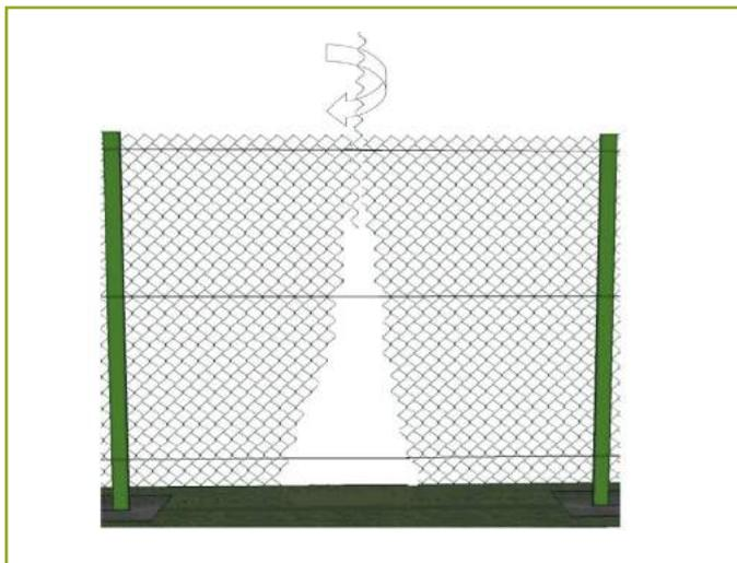
Figure 3 : illustration du tricottage d'un grillage souple (dessin Cédric Houel).
