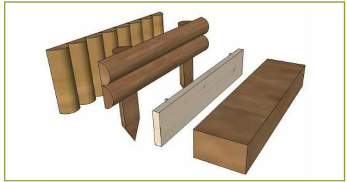
Figure 33 : Schéma des principaux types de bordures en bois (Dessin de C. Houel)
