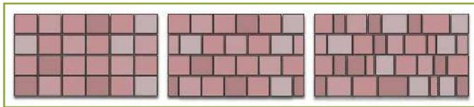
**Figure 7 :** Exemples d'appareillages. De gauche à droite : appareillage à joints alignés, appareillage en bandes à joints décalés, dallages / pavage en lignes parallèles (Dessin de C. Houel)
